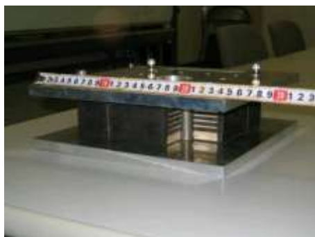
図6 免震ゴム支承（LRB）の模型
