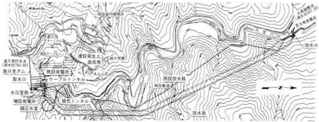
図-7 奥只見増設発電所計画平面図
