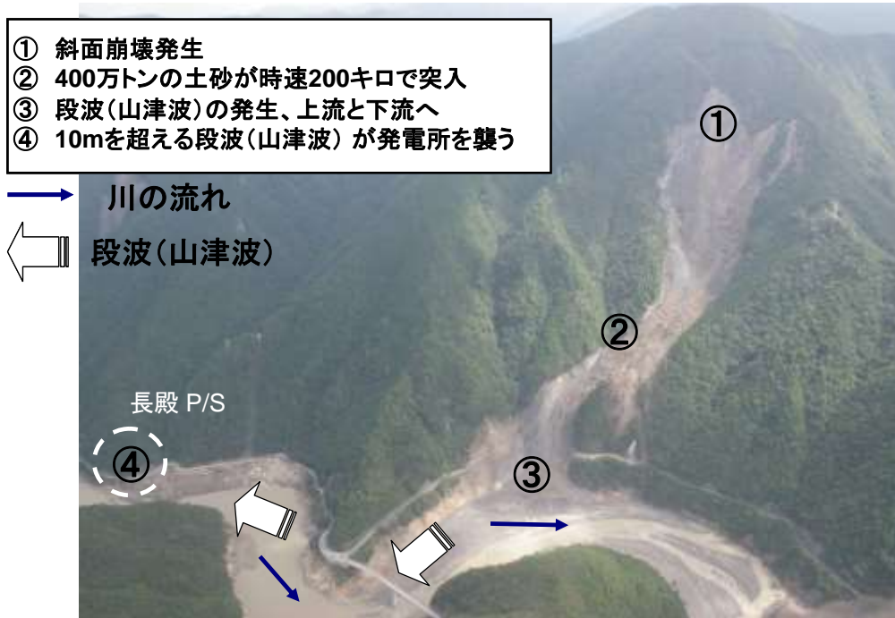
図-4 被害メカニズムの推定
