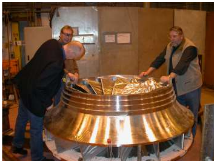
新タービンのタービン検査
