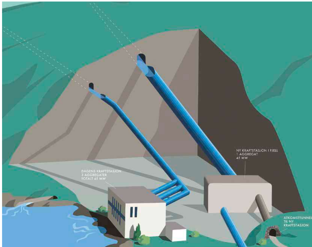
既設（左）および新設発電所（右）とそれぞれの水路のイラスト
