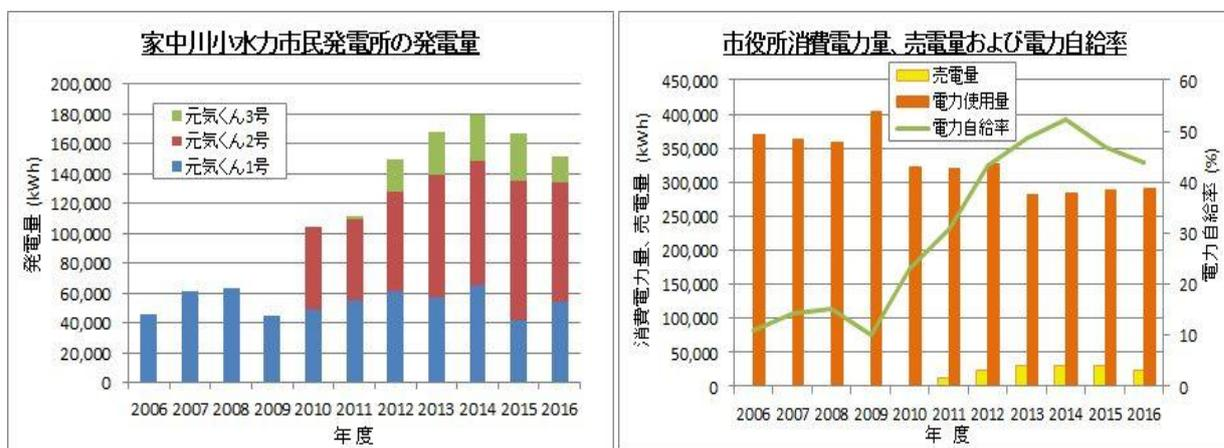
図-3 家中川小水力市民発電所発電電力量および市役所消費電力・売電量・電力自給率
