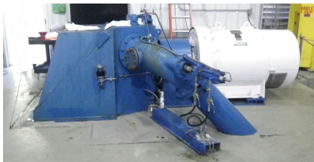
写真-1 250kW ターゴ水車発電機
