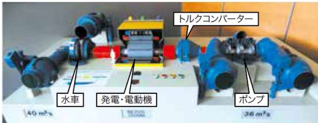
図8 ターナリー式揚水の構成
