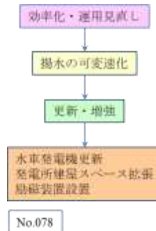
図 3.6-4: 発電所等における効率化・運用見直しによる意思決定フロー
