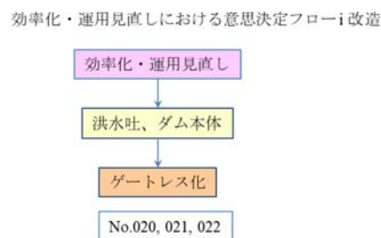
図-5.1.2-5: 洪水吐における効率化・運用見直しによる「改造」の意思決定フロー
