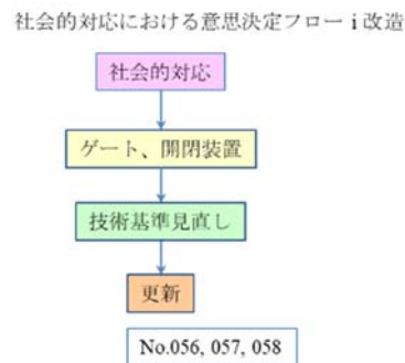
図-5.1.2-4: 洪水吐における社会的対応による「改造」の意思決定フロー
