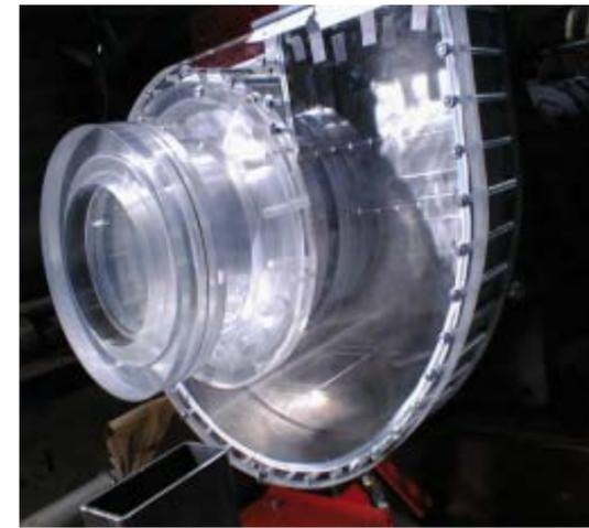
図1 Plateturbin(Sheet-metal turbine) ケーシング
