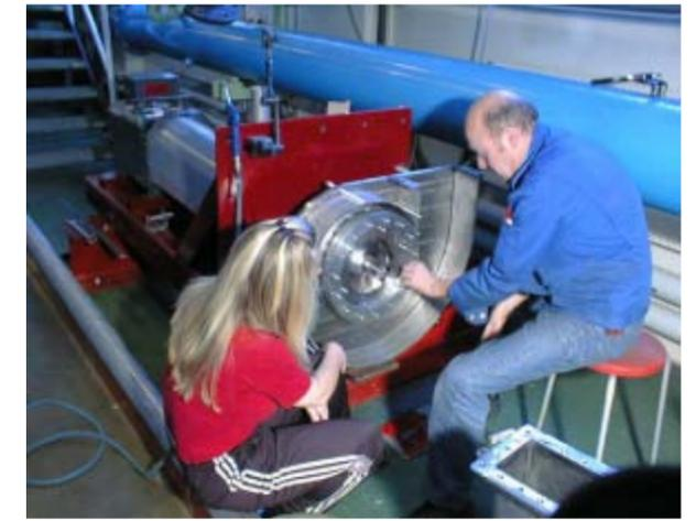
図2 Plateturbin(Sheet-metal turbine) 組み立て
