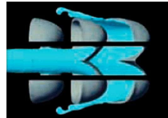
図3 バケット内での水流(コンピュータ数値解析)
