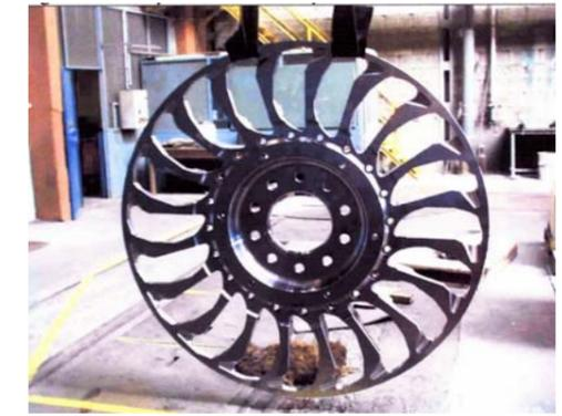
図5 フープリング外観(2個の組み合わせで一对となる)
