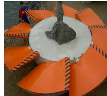
図1 VLH DN 4500型 8枚羽根 可動ブレード式水車ランナー
