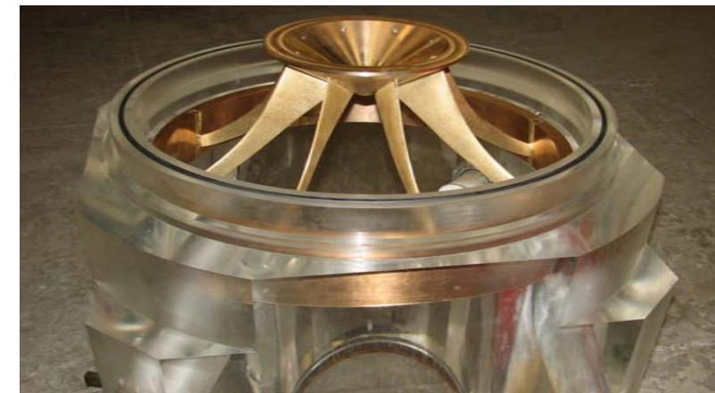
図3 工場製作時の渦流抑止ステイ外観
