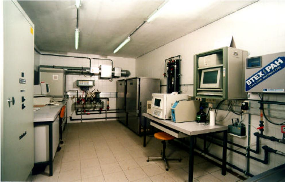
図5 オンライン水質モニタリング装置
