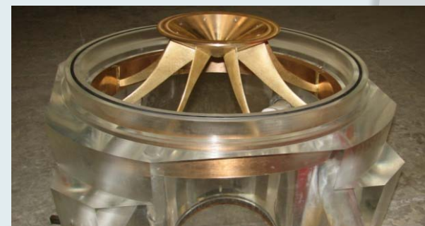
工場製作時の渦流抑止スティ外観
