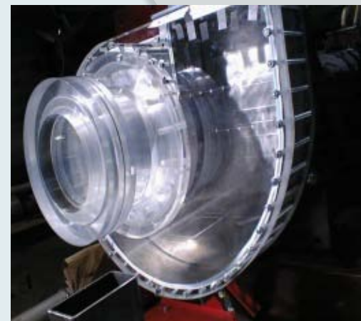
水車ケーシング
