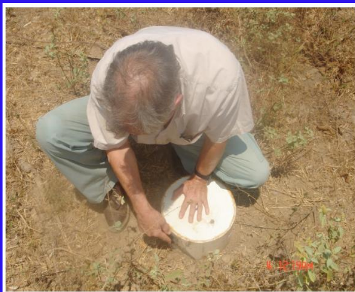
図 土壌中へのチャンバの設置 土壌中のチャンバによる温室効果ガスの採取
