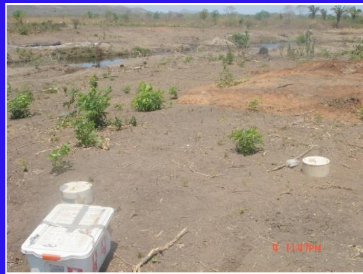
図 土壌中へのチャンバの設置 土壌中のチャンバによる温室効果ガスの採取
