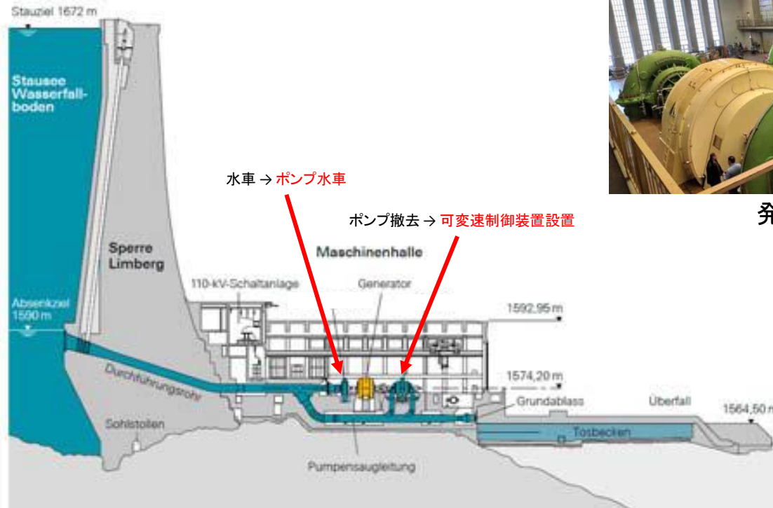
既設発電所断面図および改修案
