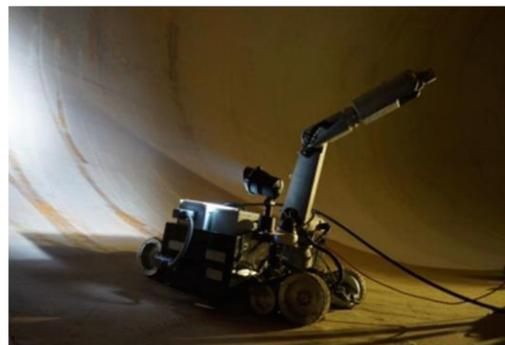
水圧鉄管の検査・補修ロボット
