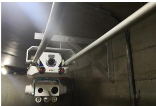
発電機空冷トンネルロボット
