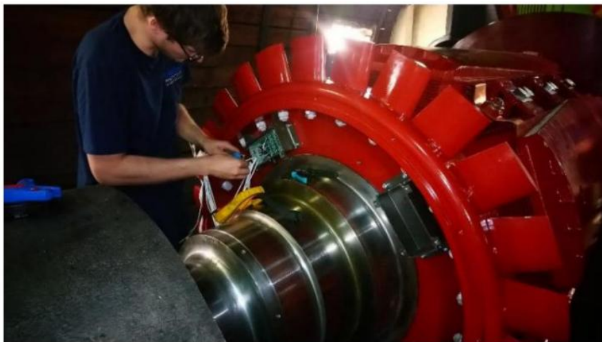
回転子へひずみ測定装置取付写真
