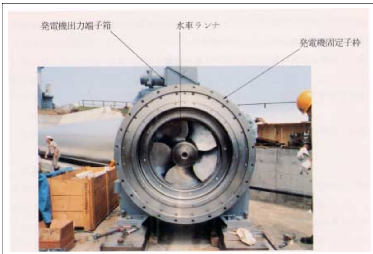
図 2-11-2 一体形水車発電装置内部構造
